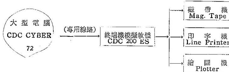
圖四 資訊傳送流程圖 (c)
