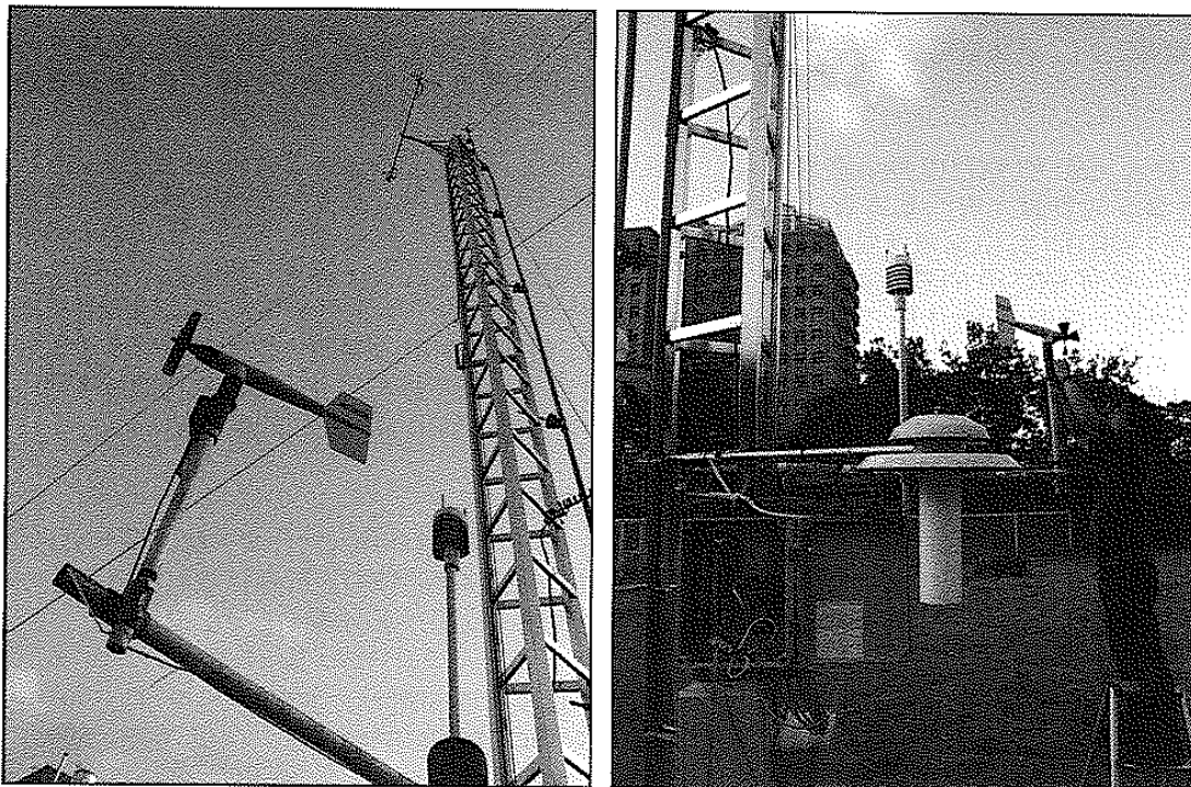
圖 2：臺灣大學大氣科學系觀測坪 NEMO 氣象鐵塔與實驗支架上的 WXT510 與 Young 5305 螺旋槳式風速風向計。
